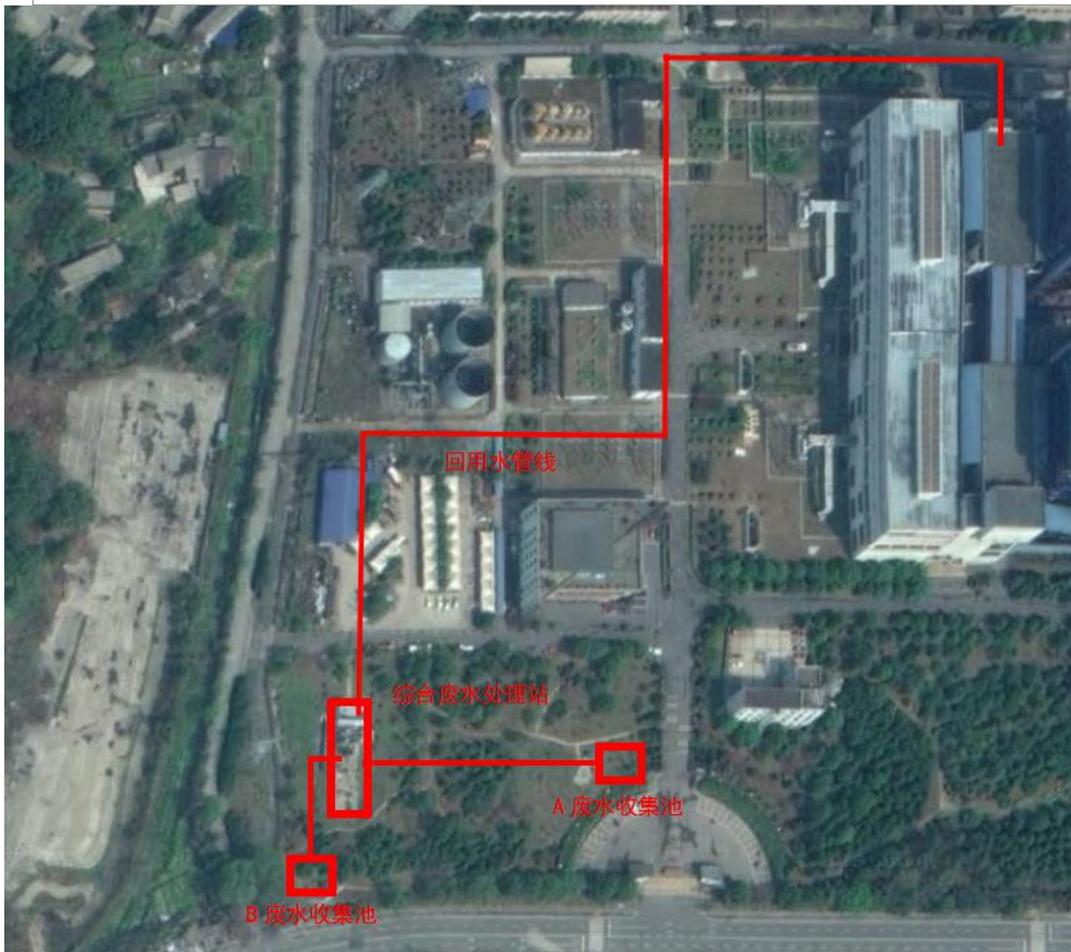
图5 项目综合废水处理站及收集管道图
