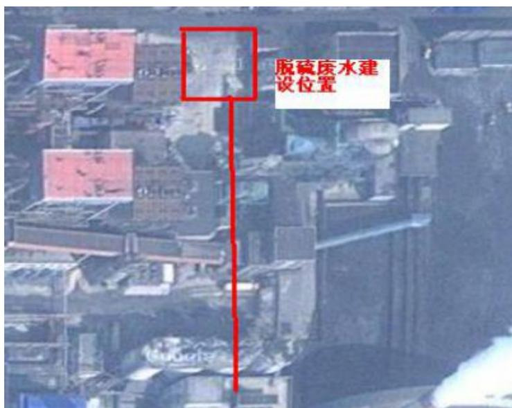
图 7 脱硫废水收集管道走向图
