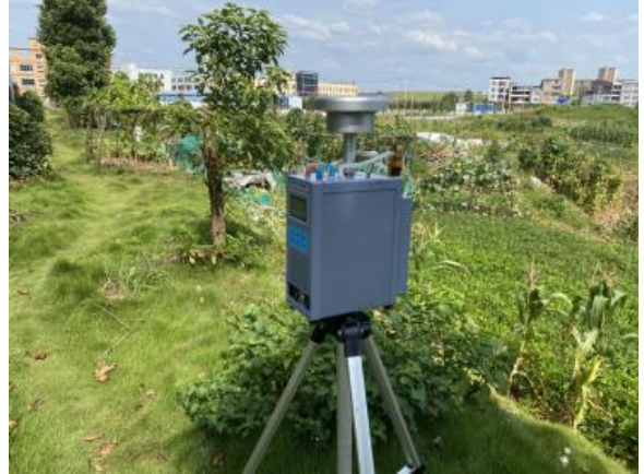
无组织废气采样照片 1
