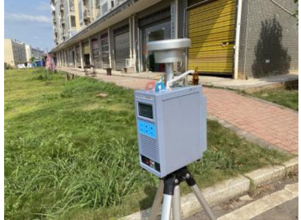
无组织废气采样照片 3
