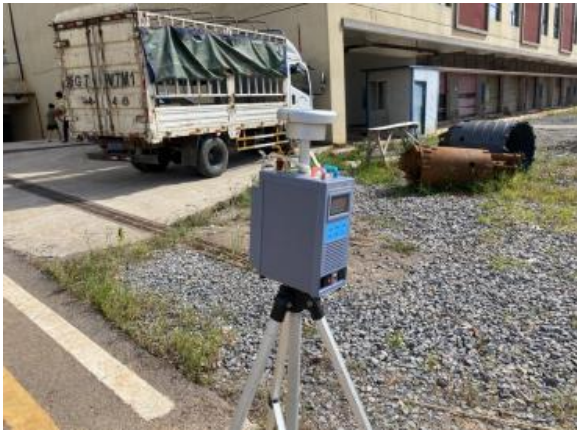
无组织废气采样照片 2
